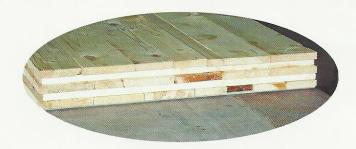
Als Wand- oder Deckenelement. Kreuzweise verlegte Lagen ergeben absolute Formstabilität ohne Schwinden oder Quellen. Mit Falz oder Nut und Feder. 6 – 40 cm stark. Bis 3.00 x 14.00 m.
